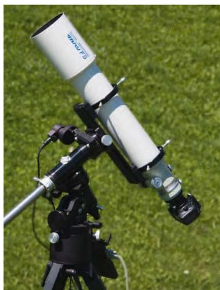
▲ Abb. 3: Klassische Linsenfernrohre eignen sich gut für die Astrofotografie. Die Ausrichtung auf das astronomische Objekt und dessen Abbildung auf dem Chip kann einfach mit der LiveView-Funktion kontrolliert werden.
