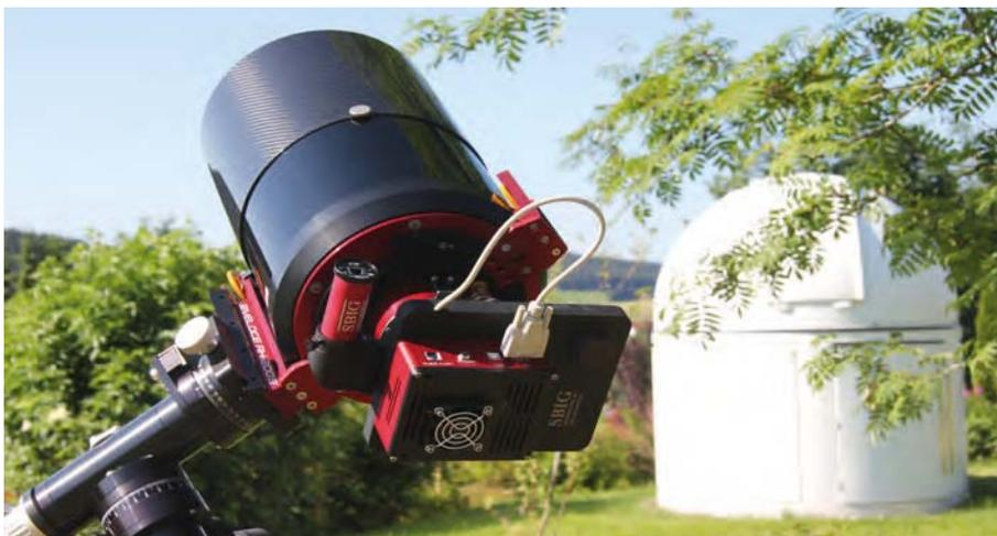
▲ Abb. 5: Astrographen sind für die Astrofotografie optimierte Teleskope, die oft über eine hohe Lichtstärke verfügen, um kurze Belichtungszeiten zu ermöglichen. Der hier abgebildete Astrograf verfügt bei einer Öffnung von 200mm über eine Brennweite von nur 600mm und weist damit ein Öffnungsverhältnis von  $f/3$  auf (das hier von einer gekühlten Astro-CCD-Kamera genutzt wird).
