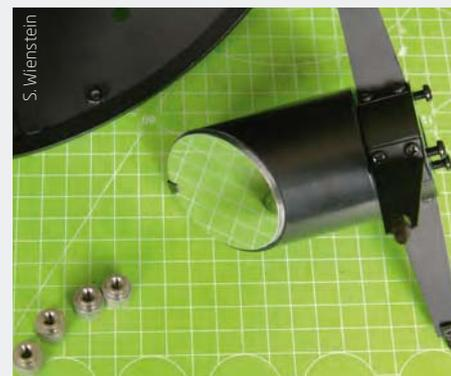
▲ Abb1: Fangspiegelzellen können den Spiegel unter Druck setzen.
