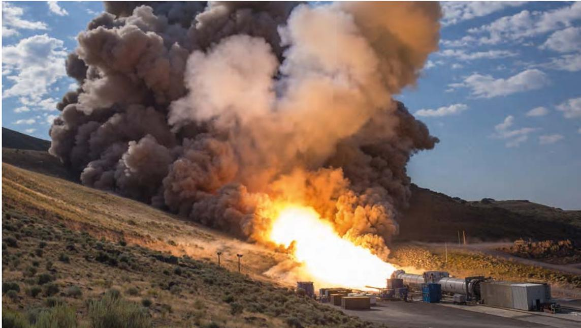
◀ Abb. 1: Der zweite Qualifikations-Motor-Test eines Boosters für das SLS, in der Testanlage von Orbital ATK Propulsion Systems bei Pro-montory, Utah.
