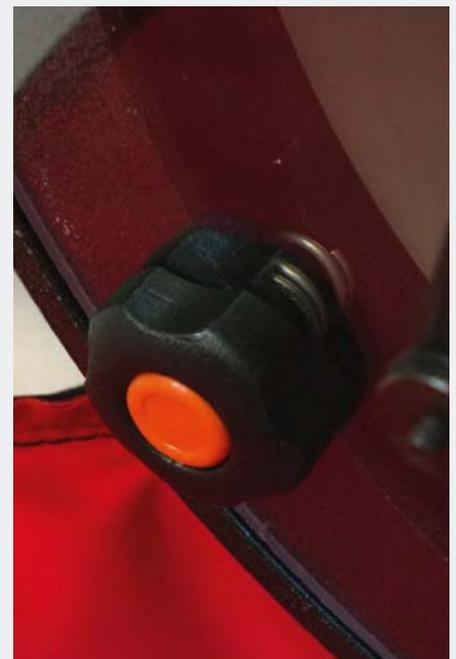
▲ Abb. 2: Federdruck zwingt die Spiegelzelle, der Justageschraube in beiden Richtungen zu folgen.
