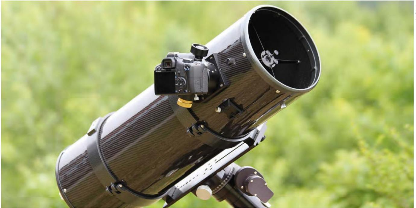
▲ Abb. 2: Mit Hilfe eines T2-Kamera-Adapters werden digitale Spiegelreflexkameras direkt mit dem Auszug des Teleskops verschraubt. Alternativ ist auch ein gesteckter Anschluss über den 2-Zoll-Anschluss möglich. Um die Teleskop-Kamera-Kombination während der langen Belichtungsdauer zuverlässig nachführen zu können, ist eine parallaktische Montierung notwendig.
