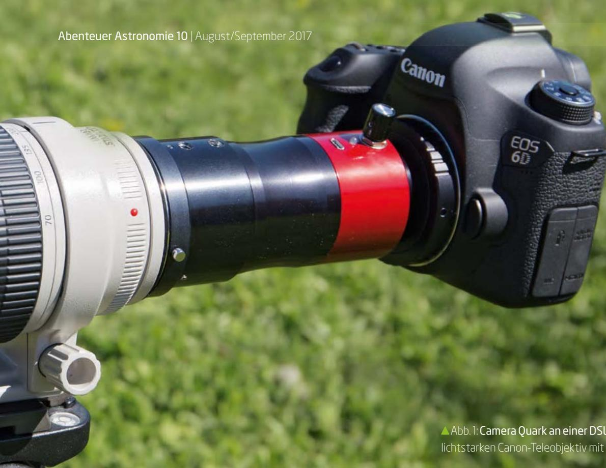
▲ Abb. 1: Camera Quark an einer DSLR vom Typ Canon 6D und einem lichtstarken Canon-Teleobjektiv mit 70-200mm Brennweite.
