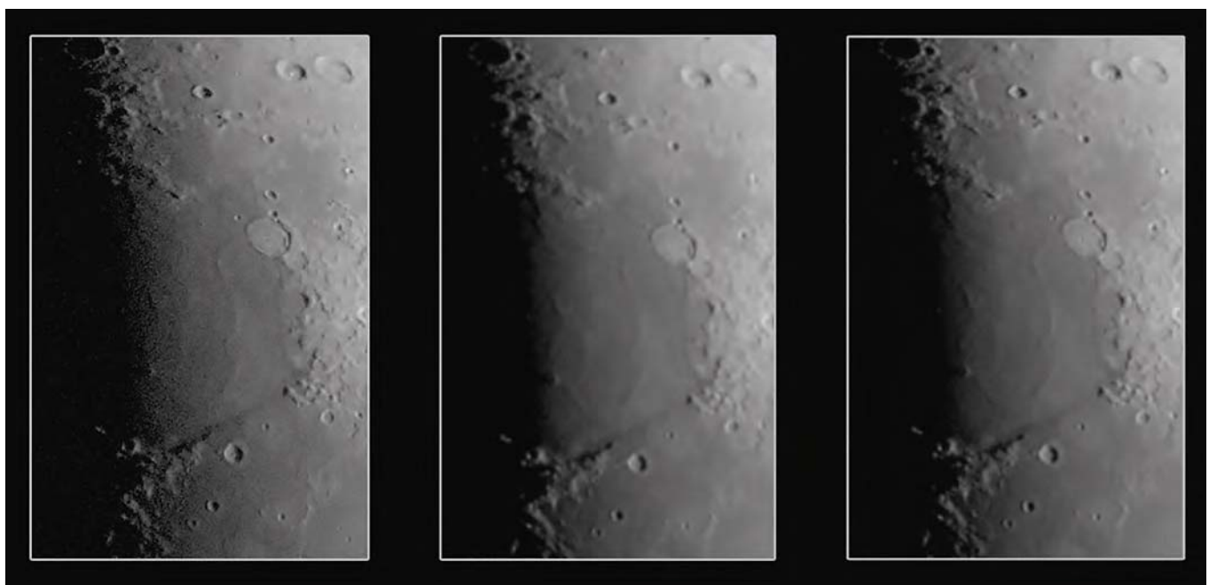
▲ Abb. 3: Vergrößerte Ausschnitte verdeutlichen die Unterschiede: Ohne Reducer (links) ist die Auflösung am besten, jedoch versinken Strukturen in Mare Serenitatis am Terminator im Rauschen. Mit Reducer (Mitte) ist die Darstellung deutlich besser, aber die Detailschärfe hat sich gleichzeitig sichtbar verschlechtert. Rechts: Ein nachträglich per Software verkleinertes Bild liefert ein etwas stärkeres Bildrauschen als das echte Reducer-Bild.
