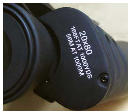
◀ Abb. 3: Typische Angaben der Kenngrößen auf dem Prismengehäuse.
