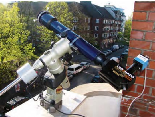
▲ Abb. 1: Das »Sunlux«-Fernrohr mit aufgesetztem ERF-Objektivfilter und Webcam im praktischen Einsatz. Hartwig Lüthen
