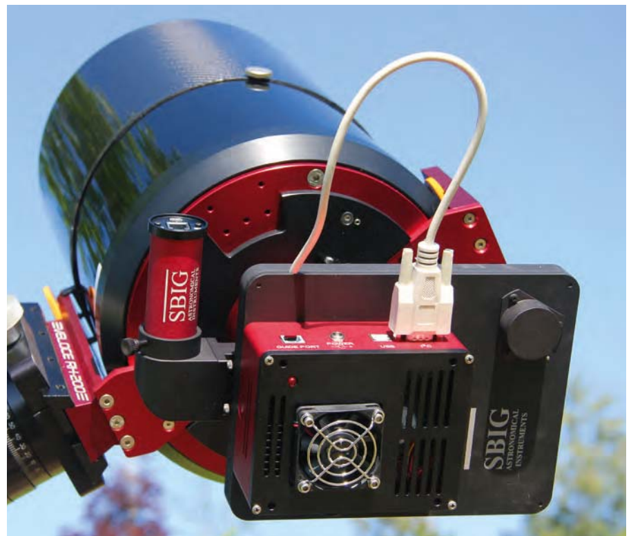
▲ Abb. 2: Eine gekühlte CCD-Kamera an einem Astrographen: Zwischen Teleskop und Kamera (rot/schwarzes Gehäuse) ist das (ebenfalls schwarze) Filterrad zu erkennen und daneben eine runde Nachführkamera (rot), die über einen Off-Axis-Guidar mit dem Strahlengang des Teleskops verbunden ist.
