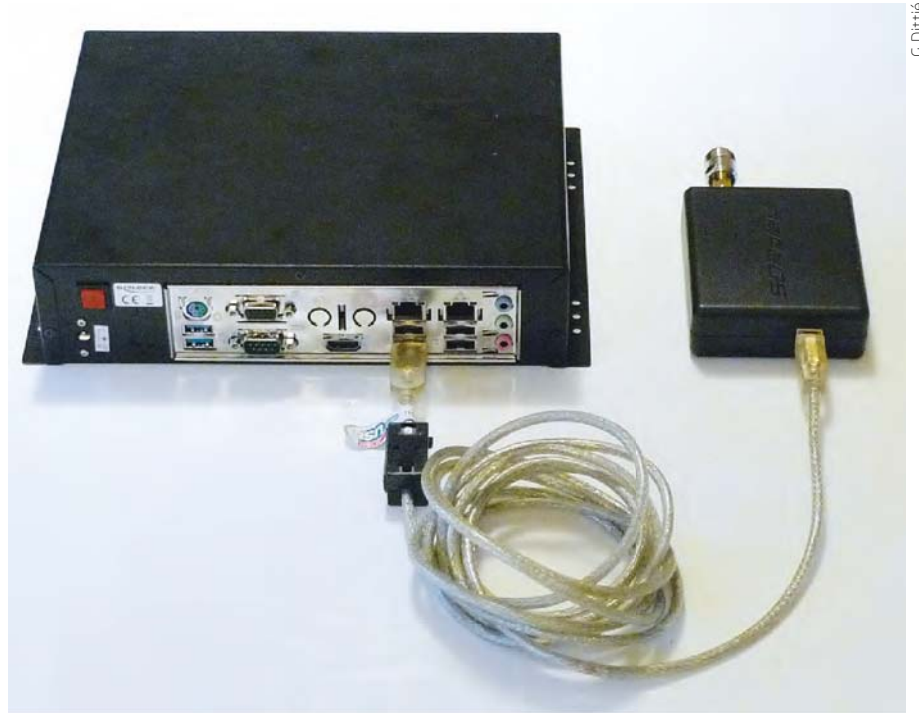
▲ Abb. 2: Empfängerhardware aus SDRplay und einem kleinen Stromspar-PC mit USB-Schnittstelle. Die Antenne wird über N-Stecker-Adapter an SDRplay angeschlossen.
