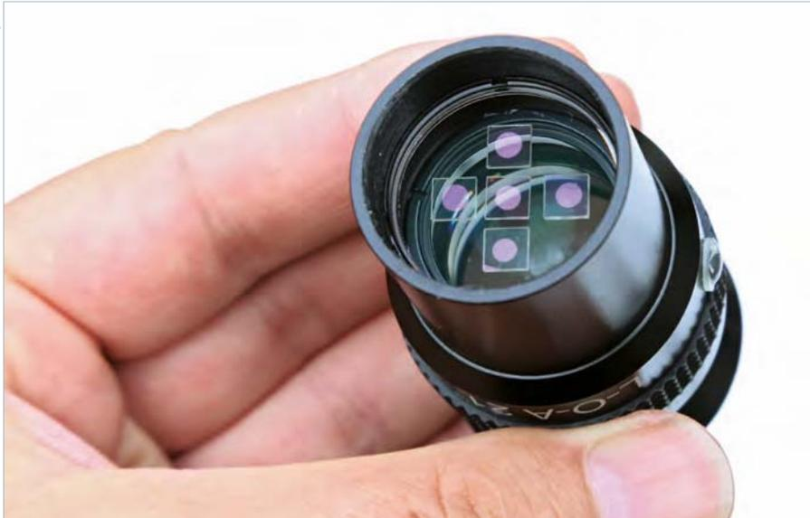
▲ Abb. 3: Blick auf das »Lederman Optical Array«. Die optisch wirksamen Plättchen sind mit Optikleber auf einer planen Platte in der Steckhülse eines der Okulare angebracht.
