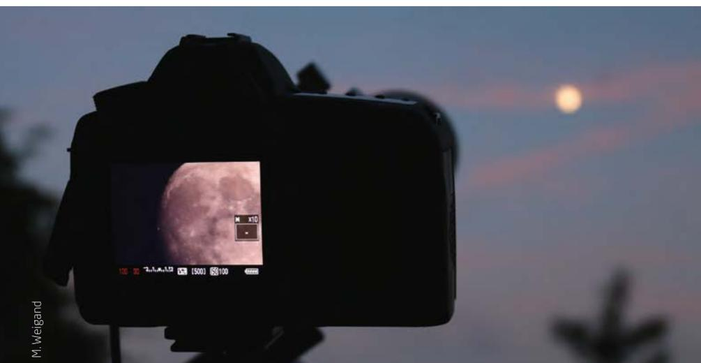
▲ Abb. 1: Mondfotografie mit der DSLR am Teleskop. Die Fokussierung des Mondes erfolgt per Liveview am Kamera-Display.
