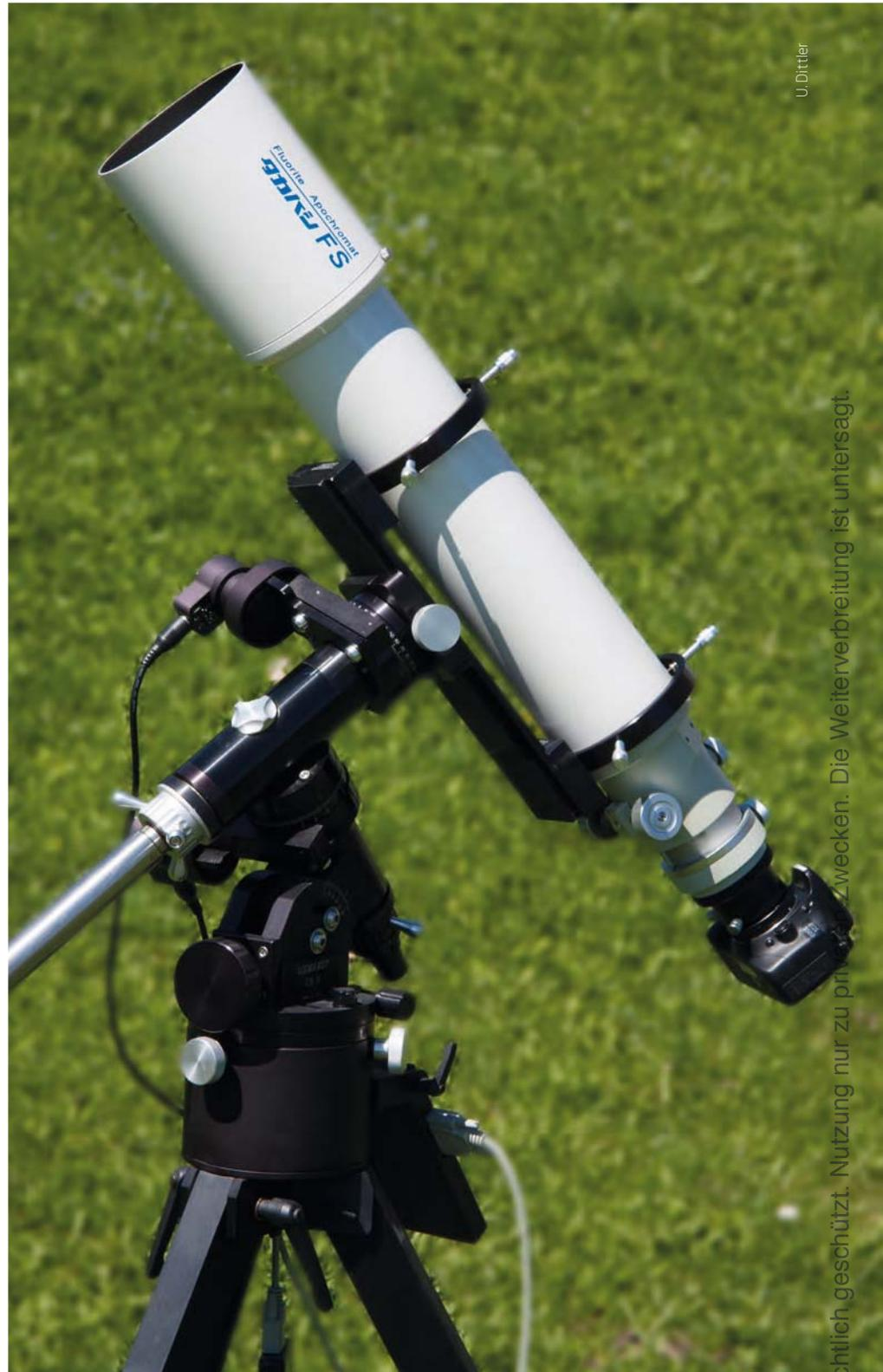
▲ Abb. 2: Die notwendige Hardware für die Kometenfotografie entspricht dem, was viele Amateurastronomen ohnehin besitzen: eine stabile Montierung, ein Teleskop (hier ein Refraktor mit rund 1000mm Brennweite) und eine adaptierbare DSLR
