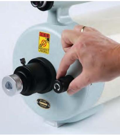
▲ Abb. 5: Ansicht der Teleskoprückseite. Scharfgestellt wird am Fokussierknopf neben dem Okularauszug, der den Hauptspiegel verstellt.
