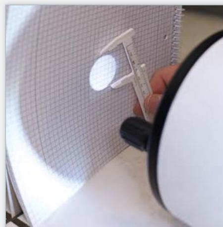
▲ Abb. 1: Mit Karopapier lässt sich der Bildkreisdurchmesser hinter dem Kameragewinde dieses Maksutov-Cassegrains abschätzen.
