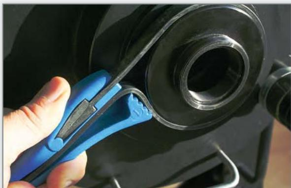
► Abb. 1: Gurtzange im Einsatz an der Adapterplatte des LX200. Die »Zähne« am Griff werden gegen den Gurt gedrückt und dann die Zange in Pfeilrichtung gedreht.
