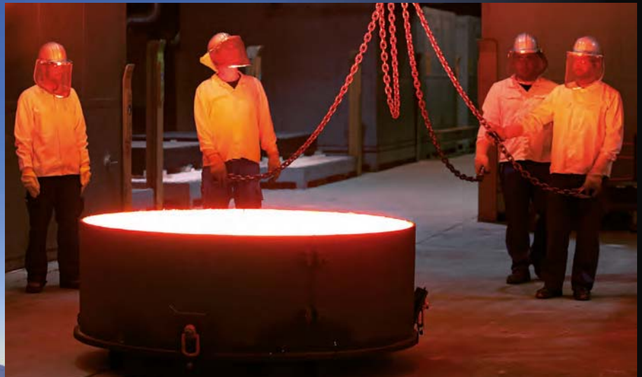
▲ Abb. 2: Die erste »boule« für die Hauptspiegelsegmente des ELT ist in Mainz fertig geworden.
