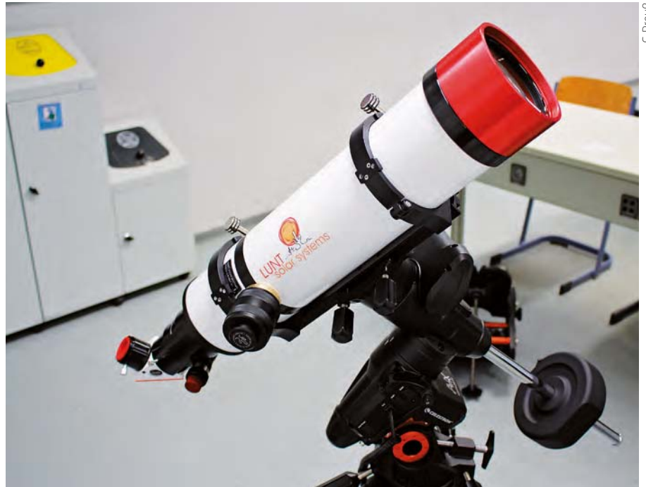
▲ Abb. 1: Das neue Sonnenteleskop der Sternwarte Siebengebirge e.V., ein Lunt Ls100 B1800 H \alpha -Teleskop von Bresser auf der neuen AVX-GOTo-Montierung von Celestron.
