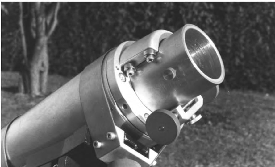
vermeiden, darf eine Taukappe nicht fehlen. Ich baute diese aus dünnem Alurohr, wobei die Innenwand mit Klebefilz ausgelegt wurde, um lästige Reflektionen zu vermeiden.
