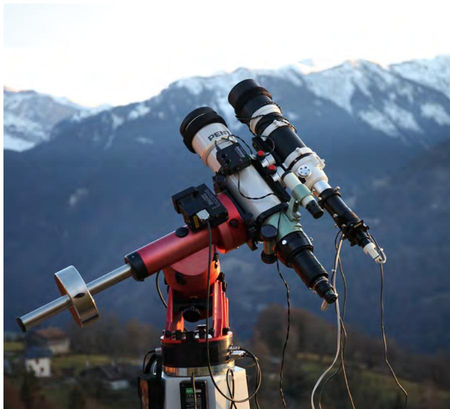
▲ Abb. 1: Autoguider-System mit huckepack montiertem Leitrohr und Exzenter für die Leitsternsuche. Mario Weigand
