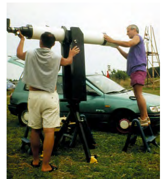
Abb. 11: Azimutale Montierungen sind bereits so beliebt, dass schon große Apochromaten damit bestückt werden.
