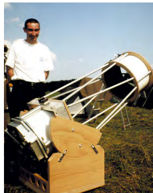
Abb. 9: Wer Alu schweißen kann, macht sich seinen Dobson eben auf diese Art.
