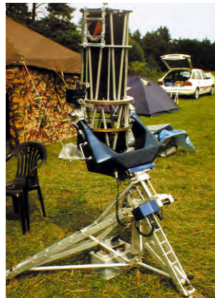
Abb. 9: Wer Alu schweißen kann, macht sich seinen Dobson eben auf diese Art.
