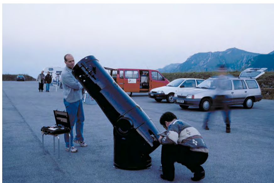
Abb. 3: Mr. Kasai (rechts kniend) mit einem aus Japan eingeflogenen Ninja-Dobson, der durch ein Klammersystem aus drei Teilen zusammengehalten wird.
