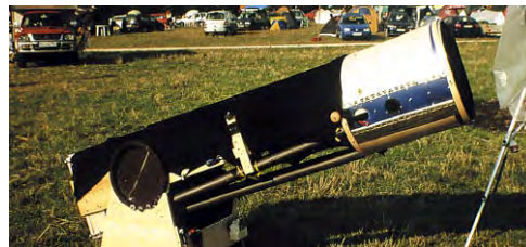
Abb. 9: Wer Alu schweißen kann, macht sich seinen Dobson eben auf diese Art.
