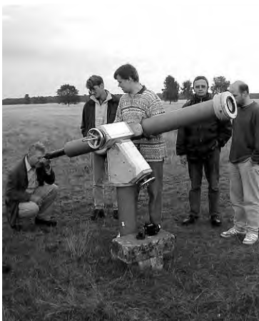
Abb. 3: Ein interessanter langbrennweitiger Selbstbaurefraktor mit Herschelkeil und schwerer Eigenbaumontierung wird für die Sonnenbeobachtung eingesetzt.
