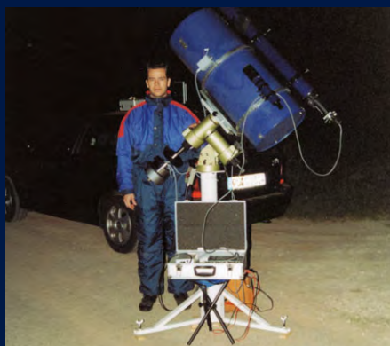
Abb. 1: Knut Schöffner mit dem 12"-Deltagraphen auf Gemini-Montierung im Einsatz am Beobachtungsort Kreen.
