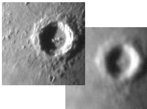
Abb. 3: Die beiden Bilder des Kraters Kopernikus zeigen den Einfluss starker Luftunruhe auf die Bildqualität. Jeweils 1/33sek mit einer Philips Webcam am 250/4000-Refraktor der Volkssternwarte München belichtet. Nur wenige Sekunden liegen zwischen den beiden Aufnahmen. Die Webcam-Aufnahmen für den Mondatlas werden nach der Aufnahme automatisch nach Qualität selektiert.
