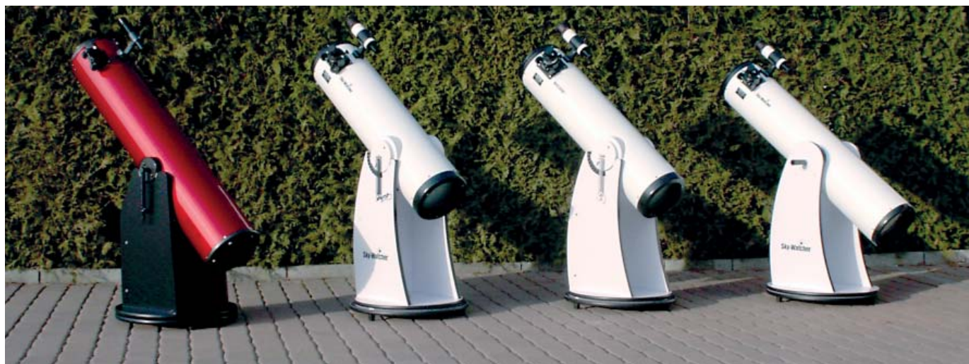
Abb. 1: Die vier getesteten Dobson-Teleskope. Von links: Galaxy D8, Skywatcher f/5, Helios f/5, Teleskop-Service Skywatcher f/6.
