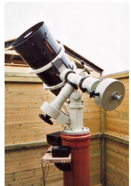
Abb. 1: Celestron C14 und Alt 5-ADN Montierung. Zwei Netzteile liegen auf der Ablage. Das eine Netzteil versorgt die Taukapfenheizung, das zweite Netzteil die FS-2 Steuerung (hier nicht abgebildet).
