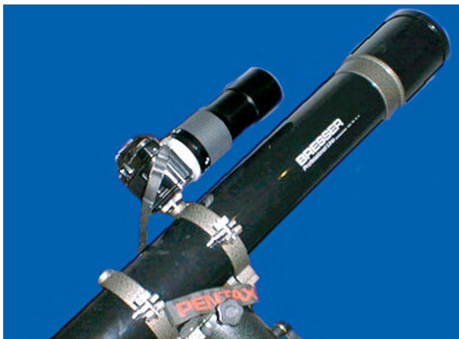
Abb. 1: Bei der Piggyback-Fotografie wird die Kamera mit Objektiv auf der Gegengewichtsstange der Montierung oder huckepack auf dem Teleskop angebracht. [Foto: Jürgen Balz]
