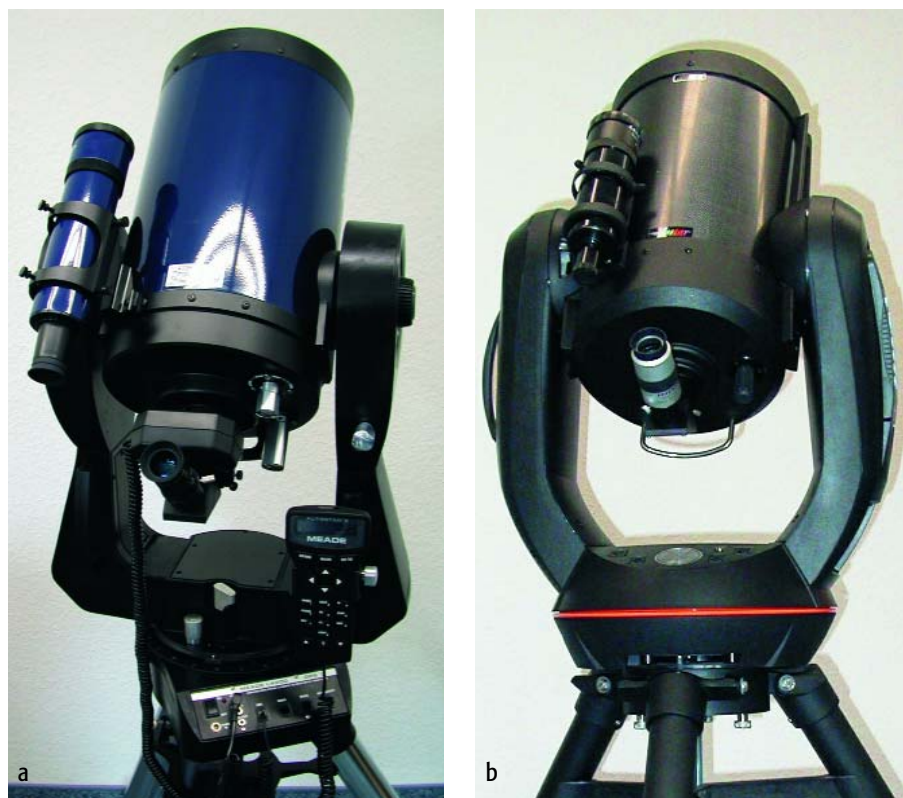
Abb. 2: Die GPS-Teleskope in der Nahbetrachtung. a) Das Meade-Teleskop kommt mit einem Motorfokussierer, der mit der Montierungsbasis durch ein Kabel verbunden ist. Gut gefallen hat uns der Sucher auf Schwalbenschwanzhalterung und die manuellen Feinbewegungen in beiden Achsen. Der GPS-Empfänger sitzt auf dem linken Gabelarm. b) Das Celestron gefällt durch sein modernes Design. Die runde Montierungsbasis dreht sich bei Bewegungen in der Azimutachse mit. Das Handgerät ist im rechten Gabelarm untergebracht, wo sich auch der GPS-Empfänger (nicht sichtbar) befindet.
