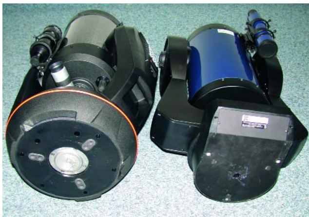
Abb. 3: Die Unterseite der Tubus-Gabel-Einheit von Meade (rechts) und Celestron (links). Beim Meade wird diese mit einer zentralen Schraube mit dem Stativ verbunden, beim Celestron mit drei Schrauben und einem Mittelstift.
