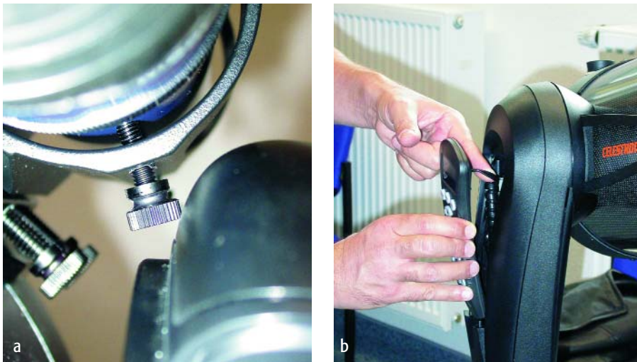
Abb. 4: Detailprobleme der Teleskope. a) Beim Meade kann die Schraube der Sucherhalterung an den GPS-Empfänger stoßen. b) Beim Celestron lässt sich die Handsteuerbox nur schwer in den Gabelarm zurückhängen
