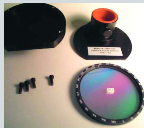
Das variable Filtersystem in seine Einzelteile zerlegt. Deutlich zu sehen die Scheibe mit den unterschiedlichen Filterbereichen.
