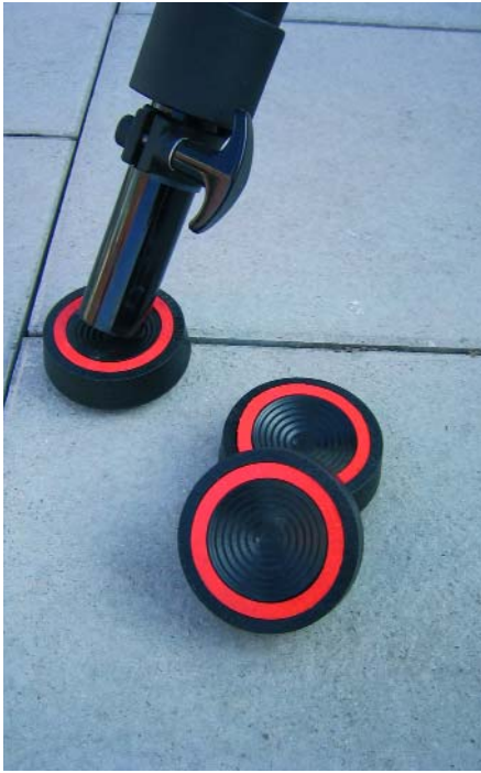
Abb. 5: Die Schwingungsdämpfer des Celestron-Teleskops sind ein großer Gewinn für erhöhte Stabilität, sowohl bei der visuellen als auch fotografischen Beobachtung.
