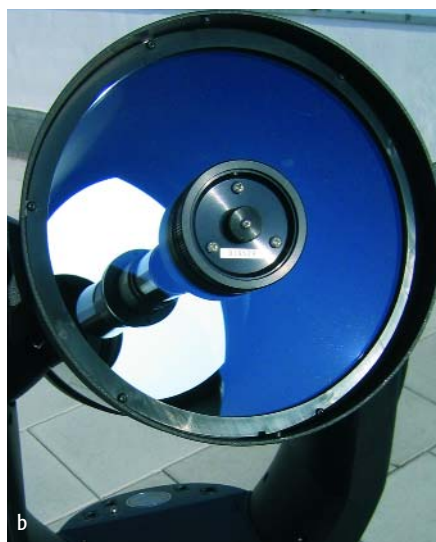
Abb. 1: Beide Testteleskope überzeugten durch gute optische Leistungen. Für die Benutzung in Mitteleuropa ist eine zusätzliche Taukappe unbedingte Voraussetzung, da die Korrektionsplatten sonst innerhalb weniger Minuten beschlagen. a) Meade 8" LX200GPS, b) Celestron Nextar8 GPS.
