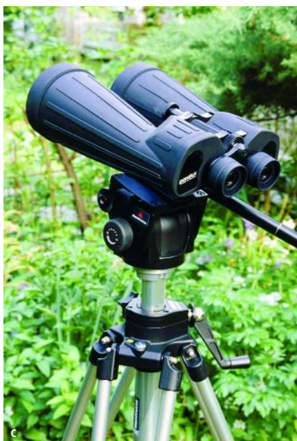
Abb. 1: Die Fotos zeigen die vier Gläser im praktischen Einsatz, jeweils montiert auf einem stabilen Studio-Fotostativ mit Video-Panoramakopf. a) Fujinon FMT-SX 2 16×70, b) Nikon 18×70 IF WP WF, c) Paralux Jumbo 20×80, d) Takahashi 22×60 Fluorite.
