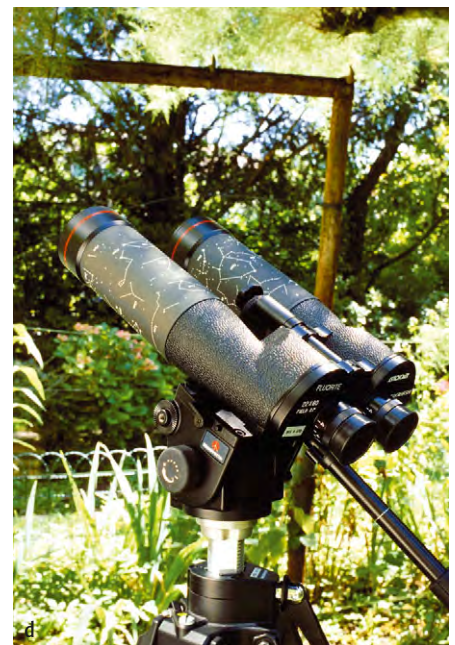
Abb. 1: Die Fotos zeigen die vier Gläser im praktischen Einsatz, jeweils montiert auf einem stabilen Studio-Fotostativ mit Video-Panoramakopf. a) Fujinon FMT-SX 2 16×70, b) Nikon 18×70 IF WP WF, c) Paralux Jumbo 20×80, d) Takahashi 22×60 Fluorite.
