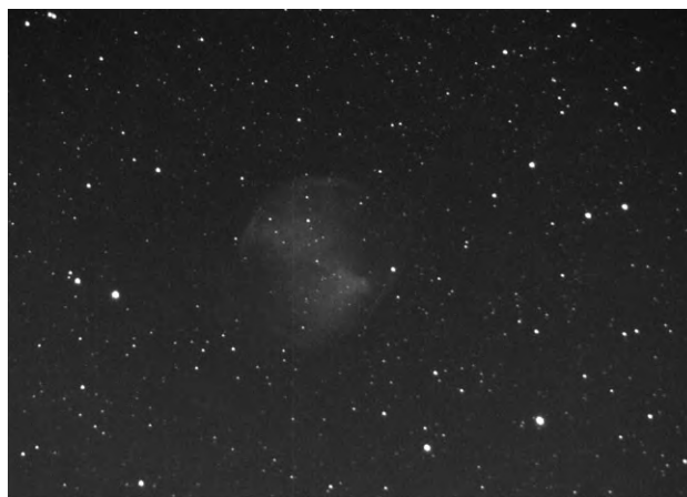
Abb. 1: Rohbild von M 27 mit Auslese- und thermischem Rauschen.
