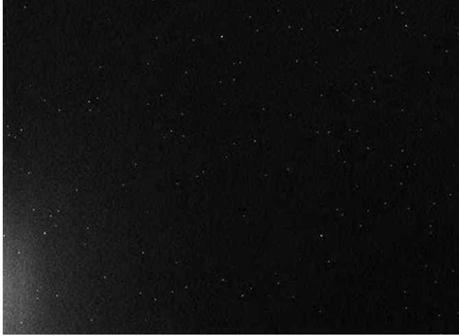
Abb. 6: Verstärkerglühen bei einigen Sony-CCD-Chips (links unten).
