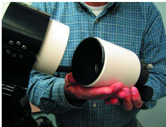
Abb. 3: Der TMB-Refraktor lässt sich ohne Aufwand in zwei Teile teilen – auch für den Transport eine schöne Sache.
