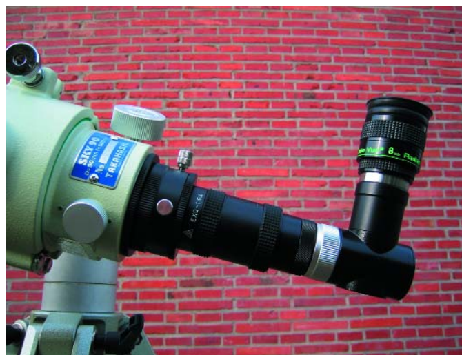
Abb. 4: Für Planetenbeobachtung mit dem Sky90 ist die Benutzung des optionalen »Extender Q« empfehlenswert.
