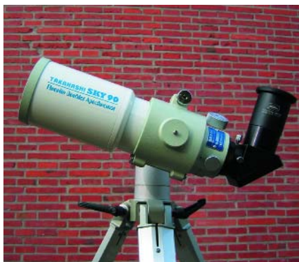
Abb. 2: Eine einziehbare Taukappe ist Standard bei edlen Kleinrefraktoren – beim Takahashi Sky90 ist sie am effektivsten ausgebildet.
