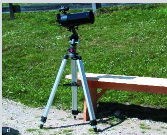
Abb. 1: Vier Reiseteleskope im praktischen Einsatz auf der Alpenhütte. a) Das Geo77 ist ein 114mm-Newton nach Art des »Astroscan«, b) Der 80/480mm-Refraktor von Guan-Sheng Optics, c) Das ETX-70AT ist mit 70mm Öffnung das kleinste Teleskop der Meade-Baureihe, d) Der 102/1400mm-Maksutov von Teleskop-Service.
