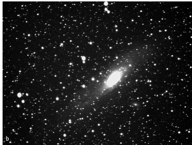
Abb. 3: Vergleich der Watec- mit der Mintron-Kamera an Hand des Andromedanebels aufgenommen mit einem 100mm/2,8-Objektiv bei Halbmond. Es wurde keine Dunkel- oder Flatfield-Korrektur vorgenommen. a) Addition von 560 Rohbilder mit je 2,5s Belichtungszeit der Mintron-Kamera, b) Addition von 139 Rohbilder mit je 10,2s Belichtungszeit der Watec-Kamera. Deutlich ist die Aufhellung am linken Gesichtsfeldrand bei der Mintron-Kamera.
