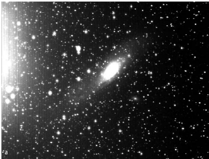
Abb. 3: Vergleich der Watec- mit der Mintron-Kamera an Hand des Andromedanebels aufgenommen mit einem 100mm/2,8-Objektiv bei Halbmond. Es wurde keine Dunkel- oder Flatfield-Korrektur vorgenommen. a) Addition von 560 Rohbilder mit je 2,5s Belichtungszeit der Mintron-Kamera, b) Addition von 139 Rohbilder mit je 10,2s Belichtungszeit der Watec-Kamera. Deutlich ist die Aufhellung am linken Gesichtsfeldrand bei der Mintron-Kamera.
