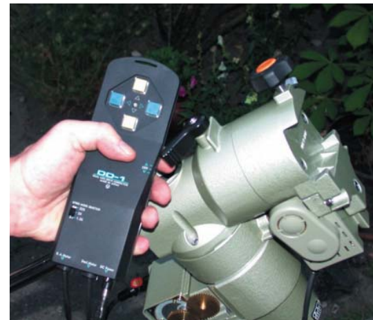
Abb. 5: Übersichtlich: Die Handsteuerbox »DD-1« der GP-E-Montierung.
