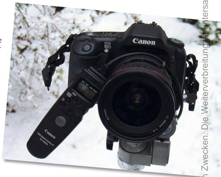
Abb. 1: Die Canon EOS 10D mit Timer-Auslösekabel TC-80N3 und Zoom 17–40mm
