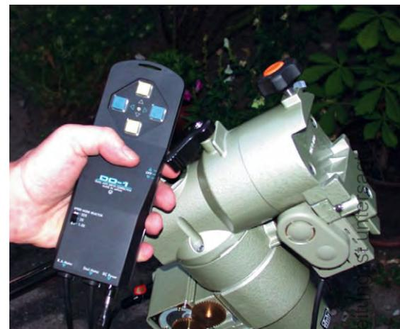
Abb. 5: Übersichtlich: Die Handsteuerbox »DD-1« der GP-E-Montierung.
