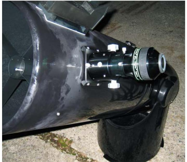
Abb. 3: Das Televue Nagler 31mm am taubeschlagenen Ninja 320mm Dobson.
