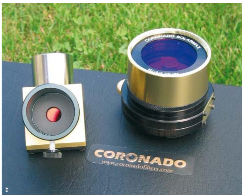
Abb. 4: Während das PST als komplettes Teleskop inklusive Koffer kommt (a), besteht der Solarmax-Filter aus zwei Komponenten: Das Etalon (rechts) wird auf die Teleskopöffnung gesteckt, während das Zenitprisma mit integriertem Blockfilter (links) in den Okularauszug kommt (b).
