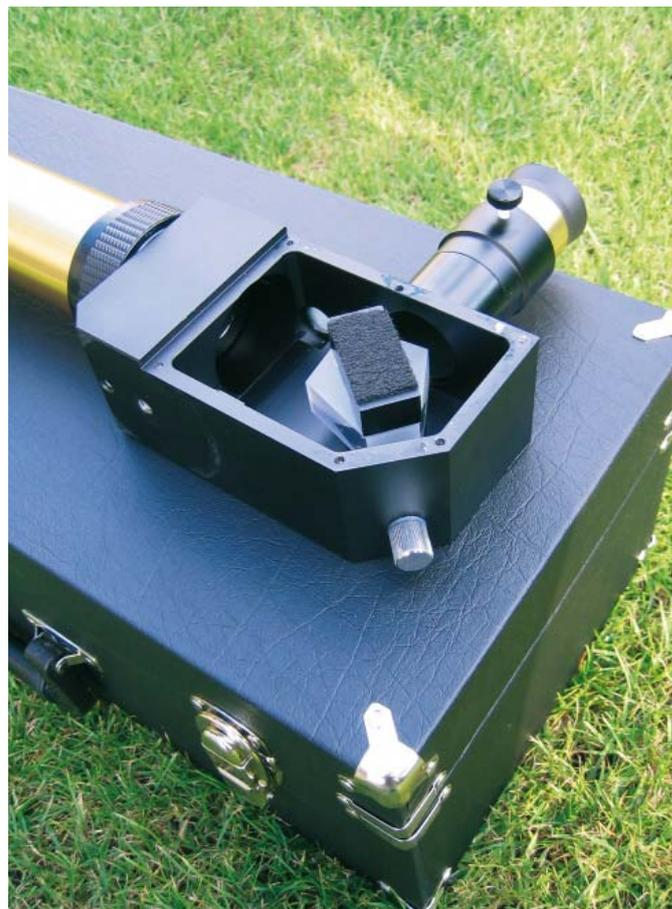
Abb. 3: Blick in das Innere des PST. Die Fokussierung erfolgt über den Rändelknopf auf der unteren Seite des Teleskopkörpers.
