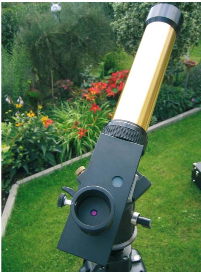
Abb. 2: Blick auf das Okularende des PST. Zu erkennen sind das Fenster des Sonnensuchers sowie der 5mm-Blockfilter im Okularstutzen.
