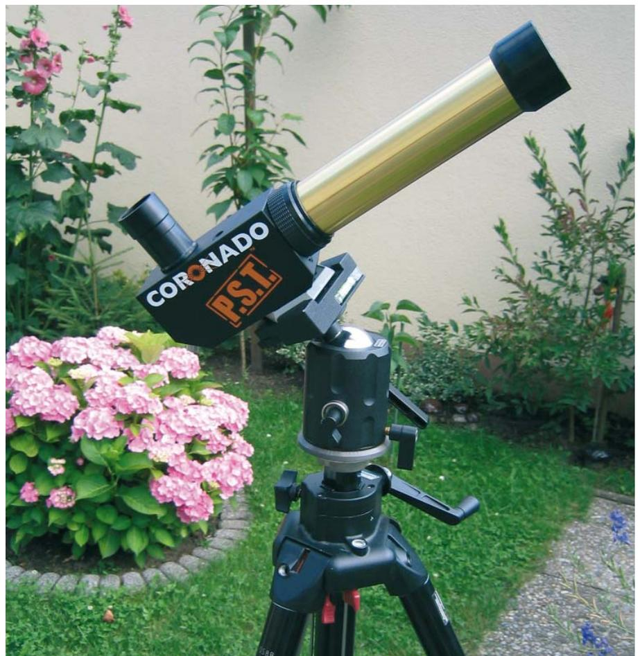
Abb. 1: Das »Personal Solar Telescope« (PST).
