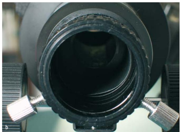
Abb. 5: Lichtreflexe im Okularauszugsrohr des Lidl-Refraktors im ursprünglichen Zustand (a) und nach der Auskleidung mit schwarzem Tonpapier (b).
