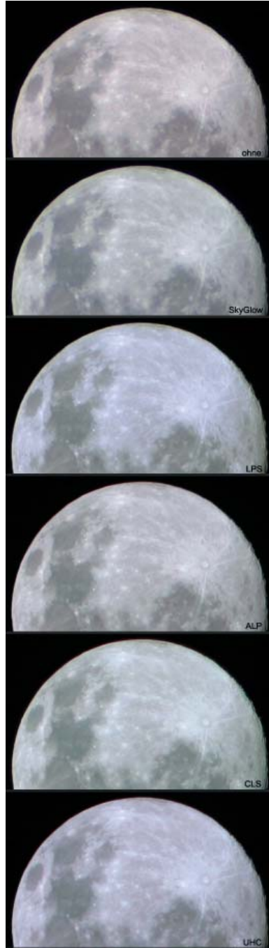
Abb. 6: Aufnahmen des Mondes mit dem 80/400-Refraktor und der Canon EOS 10D (ISO 100, Weißabgleich »Sonne«, Bildformat JPG). Aus einer Serie von jeweils vier Fotos mit einem Filter bei jedesmaliger neuer Scharfstellung wurde das schärfste ausgesucht. Die Belichtungszeiten wurden für einheitliche Helligkeit der Lichter gewählt und die Eigenfarbe der Filter wurde per Bildbearbeitung kompensiert. [P. Wienerroither]
