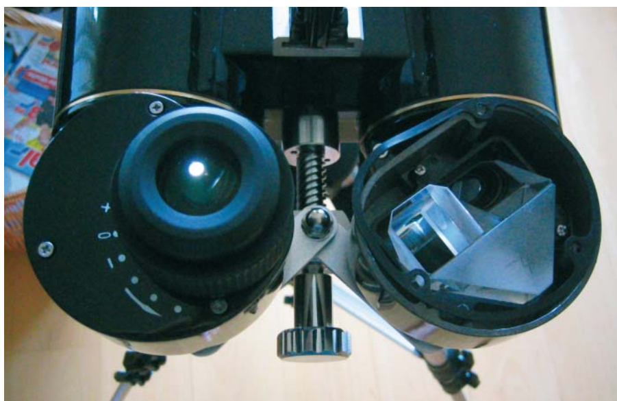
Abb. 5: Blick in das Prismengehäuse des 20×88 BT von Teleskop-Service. Die Prismen sind mit je drei Druck- und Zugschrauben voll justierbar.
