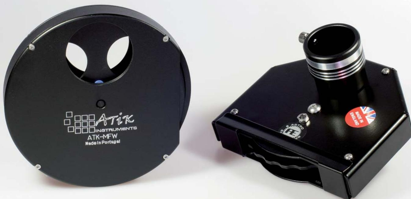
Abb. 2: Filterräder sind sehr empfehlenswert für ausgiebige visuelle Beobachtungen. Früher praktisch unerschwinglich, sind nun zwei preiswerte Räder für 1¼"-Okulare auf dem Markt: Das Modell der Firma Atik (links) besitzt einen T-Anschluss und kann fünf Gläser aufnehmen, während das Filterrad von Astro Engineering (rechts) ebenfalls fünf Filter fasst, aber bereits mit Steckfassung für 1¼"-Okulare kommt.
