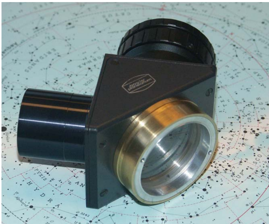
Abb. 2: Selbstgebautes 1,25"-Herschelprisma. Das Gehäuse stammt von Baader Planetarium, die Keilplatte noch aus Zeiss-Beständen. Die Graufilter werden in das Okular geschraubt.
