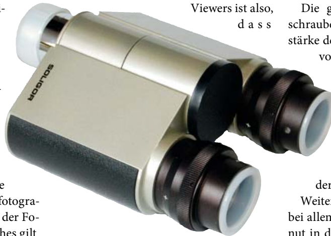
Abb. 4: Das Soligor-Binokular fällt schon äußerlich aus der Reihe. In ihm stecken optische Komponenten, die den Strahlengang nicht nur aufspalten, sondern auch um 180° drehen und den Brennpunkt verlängern.
