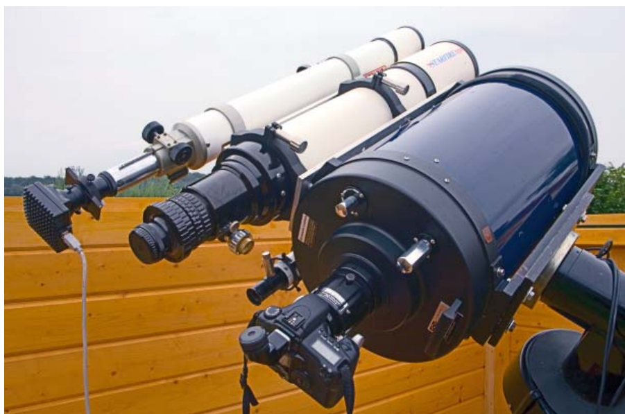
Abb. 2: 12"-LX200R-Optik auf Sideres 85 Montierung. Der monochrome Meade DSI pro mit USB-Anschluss diente als Autoguider. Sinnvoll: die bei RC- und SC-Optik vorhandene Hauptspiegelarretierung per Drehkopf.
