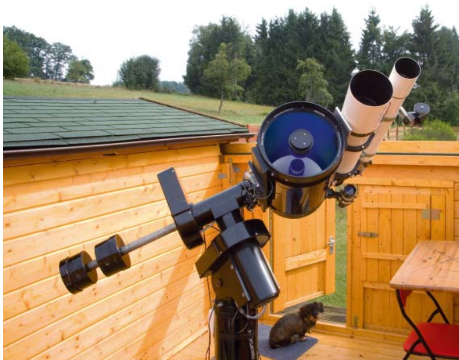
Abb. 1: 12"-LX200R mit AP 130mm EDFS und 80/910mm-Leitrohr auf der Sideres 85 Montierung. Die beiden Testoptiken wurden jeweils mit einer gesondert gefertigten Schiene an der Montierung befestigt. Als Montageschiene empfiehlt sich die Losmandy-Prismenschiene mit zwei Lagerböcken (nicht im Bild).
