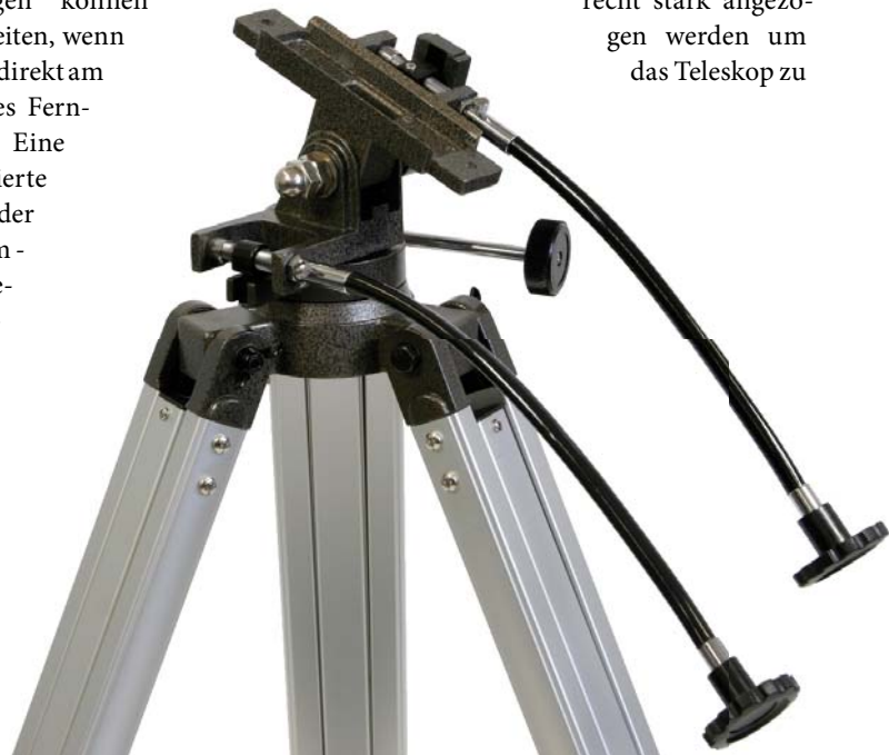
Abb. 6: Der AZ-3-Montierung sieht und fühlt man die chinesische Herkunft an. Fernrohre mit Prismenschiene lassen sich überhaupt nicht montieren, die Gängigkeit der Bewegungen sind kaum einstellbar (oben). Da helfen auch die Feinbewegungen nicht (rechts).
