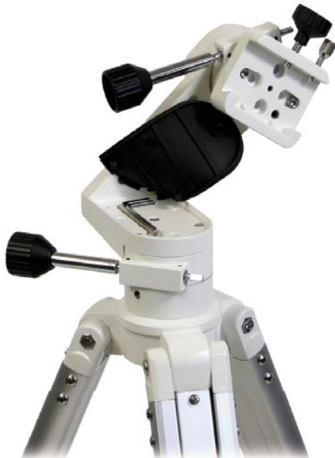
Abb. 3: Fest mit dem Stativ verbunden ist die Vixen Porta-Montierung , deren Design auf das Vixen-Teleskop abgestimmt ist (links). Zwei Feinbewegungsschrauben erlauben ein genaues Einstellen der Montierung, will man die Grobbewegungen einstellen, muss man auf das Werkzeug in der Gabelbasis zurückgreifen (rechts).
