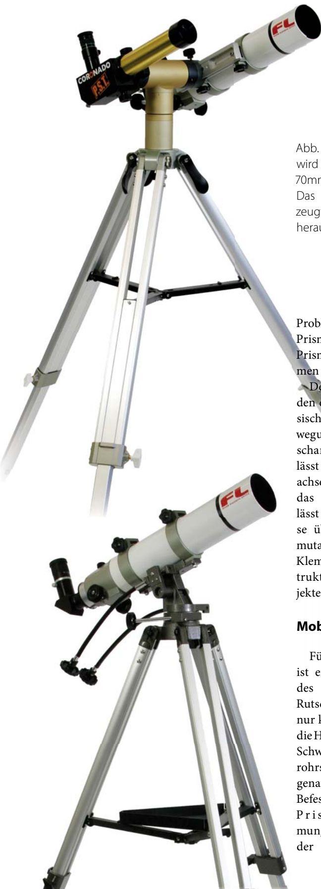
Abb. 6: Der AZ-3-Montierung sieht und fühlt man die chinesische Herkunft an. Fernrohre mit Prismenschiene lassen sich überhaupt nicht montieren, die Gängigkeit der Bewegungen sind kaum einstellbar (oben). Da helfen auch die Feinbewegungen nicht (rechts).
