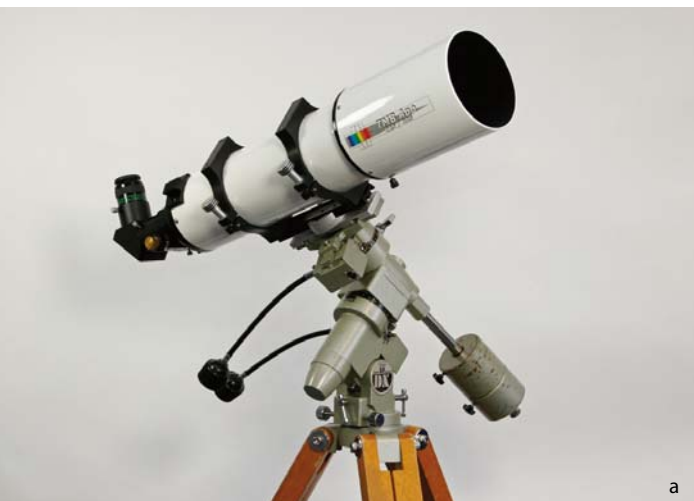
Abb. 2: Der TMB Super-Apo besitzt trotz größter Öffnung das kürzeste Transportmaß im Vergleich (a). Dies wird durch einen einschiebbaren Okularauszug erreicht (b).
