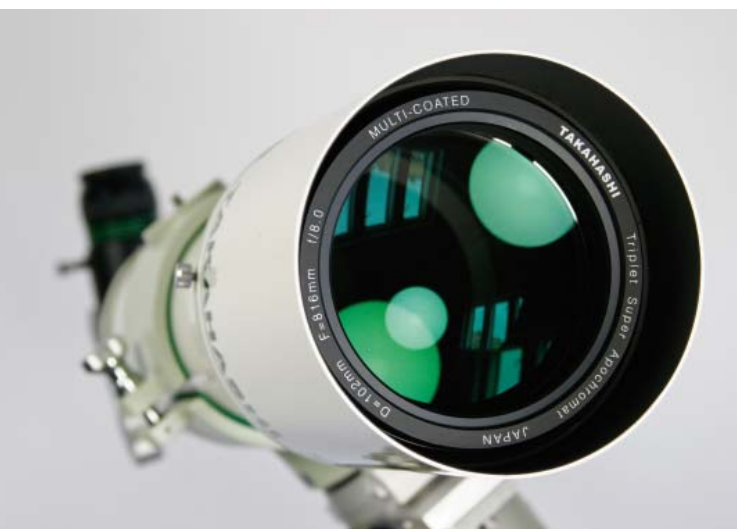
Abb. 1: Hochwertige dreilinsige Objektive mit Sondergläsern sind die Nachfolger der jahrelang dominanten Zweilinsler mit Fluorit-Element. Alle drei Teleskope besitzen diese Objektivkonstruktion: TMB LW 115/805, Takahashi TSA 102, William Optics FLT 110.
