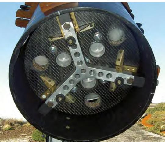
Abb. 4: **Die Unterseite der Spiegelzelle.** Das Aluminiumkreuz ist mit dem Tubus verschraubt und hält den Spiegelträger, der über die Justierschrauben justiert wird. Madenschrauben mit Druckfedern dienen zur Sicherung der Justage.
