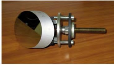
Abb. 6: **Die Fangspiegelhalterung.** Gut zu erkennen sind die Druckschrauben zur Justage und die zentrale Hutmutter, die in eine Bohrung greift und als Gegenlager dient.
