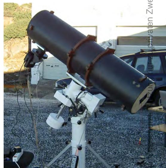
Abb. 2: Der 12,5"-Newton-Astrograph auf einer MAM-50 Montierung. Auf der Rückseite des Tubus ist die Schaumstoffmatte zu sehen, die den Lüfter beherbergt.
