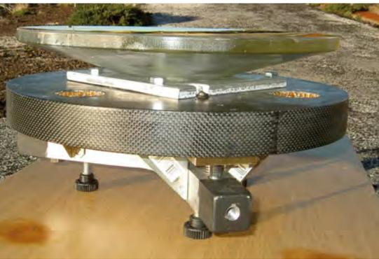
Abb. 3: **Der Hauptspiegel mit konischem Querschnitt**, montiert auf der Spiegelzelle. Das Design der Spiegelzelle ist historisch bedingt etwas komplexer als im Text dargestellt. Ebenfalls sind die Bohrungen im Spiegelträger zu erkennen, durch die der Spiegel vom Lüfter angeblasen und auf Umgebungstemperatur gebracht wird.
