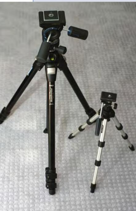
Abb. 1: Ein solides Dreibeinestativ und ein einfaches Kompaktstativ im Vergleich. Während das große Stativ auch schwerere Kameras ohne Stabilitätsverlust trägt, sollte man dem Kompaktstativ nur leichtere Lasten aufsatteln und Stativbeine und evtl. vorhandene Mittelsäule nicht ausziehen.
