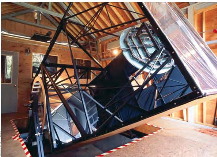
Abb. 6: Mit dem »Optical SETI Telescope« des Oak Ridge Observatoriums in Harvard, Massachusetts suchen die SETI-Anhänger gezielt nach Laserblitzen ferner Zivilisationen.
