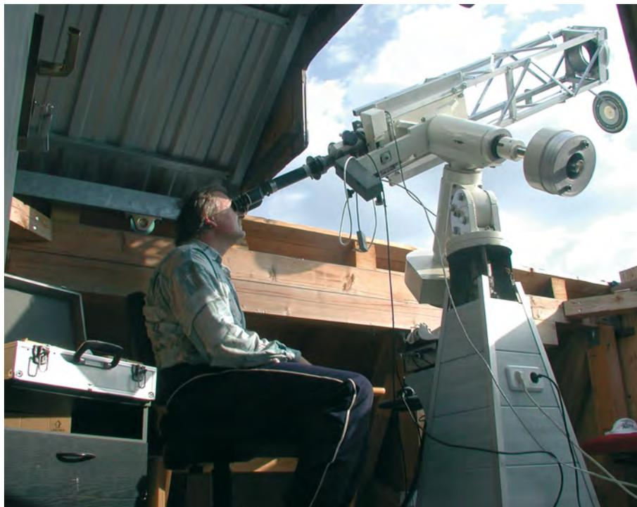
Abb. 1: Der Unigraph ist ein neuartiges, für hochauflösende Sonnenfotografie optimiertes Teleskop. Im Bild der 150/1200mm-FH-Unigraph auf schwerer deutscher Montierung und verstärkter Zeiss-Guss säule. Die Höhe des Instruments über Boden beträgt 3,5m, das Gewicht des Tubus 18kg. Man erkennt eine Objektivklappe, welche vom Okularende aus zu bedienen ist. Am Okularende ist ein Binokular zur visuellen Beobachtung angesetzt.
