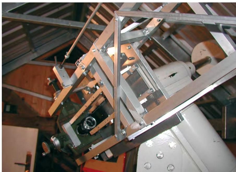
Abb. 3: **Der Alugittertubus** mit verschraubten und verschweißten Dreiecksverstrebenungen. Wenn die  $10\text{mm} \times 10\text{mm}$  Profile an den entsprechenden Stellen ausgesägt und im  $90^\circ$ -Winkel einmal gebogen werden, genügt eine M6-Gewindeschraube zur Befestigung mit den  $20\text{mm} \times 20\text{mm}$  Alubasisprofilen.
