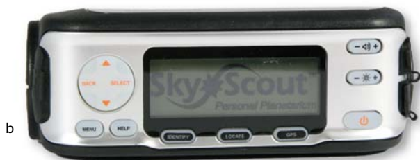
Abb. 3: Blick auf die Bedienungsoberfläche. Bei Meades MySky sind die Steuertasten unterhalb des Bildschirms und der Visiereinrichtung angebracht (a), bei Celestrons SkyScout findet man sie seitlich um den Bildschirm gruppiert (b).
