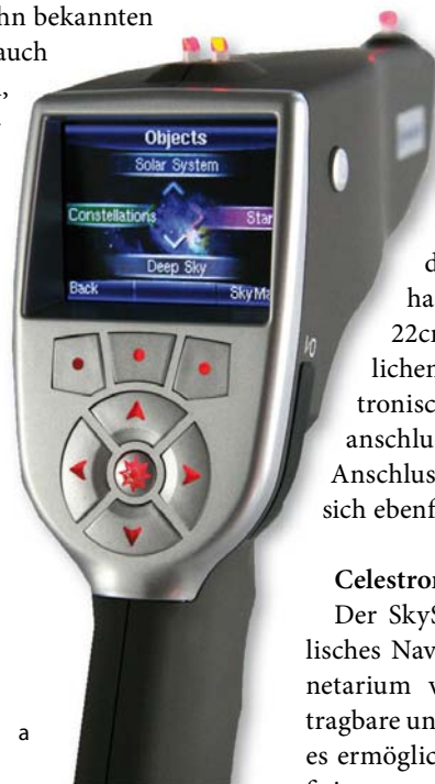
Abb. 3: Blick auf die Bedienungsoberfläche. Bei Meades MySky sind die Steuertasten unterhalb des Bildschirms und der Visiereinrichtung angebracht (a), bei Celestrons SkyScout findet man sie seitlich um den Bildschirm gruppiert (b).
