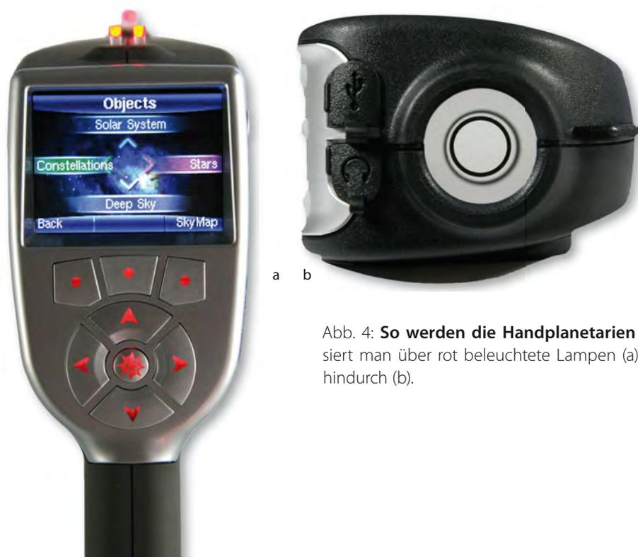
Abb. 4: **So werden die Handplanetarien an den Himmel gerichtet:** Beim MySky viert man über rot beleuchtete Lampen (a), beim SkyScout blickt man durch das Gerät hindurch (b).
