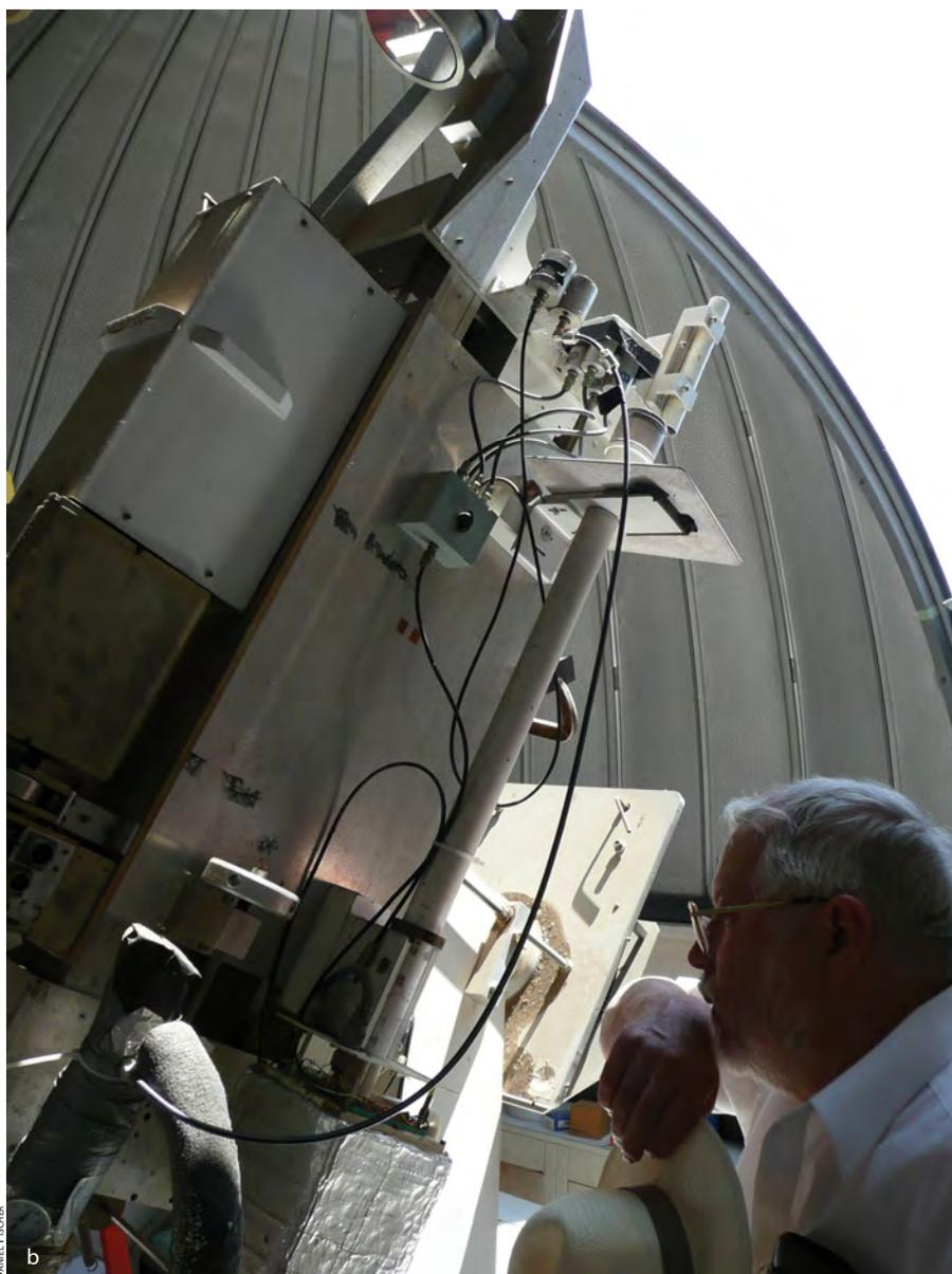
Abb. 2: **Das San Fernando Observatory** im kalifornischen Sylmar (a) wird von Gary Chapman geleitet (b). Das schmale Rohr ist das CDFT1, das schon über zwei Jahrzehnte lang täglich die Sonne beobachtet – und möglicherweise auf regelmäßige Durchmesser-schwankungen gestoßen ist.
