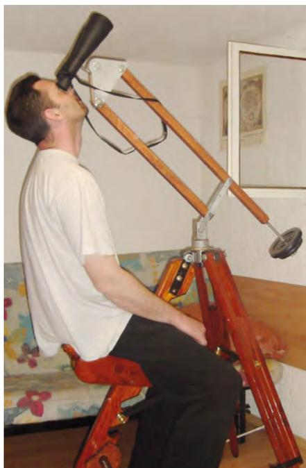
grund der örtlichen Gegebenheiten baute der Autor einen Beobachtungsstuhl, der als Hybrid aus einem »Denver-Stuhl« und einem normalen Dreibeinstativ bezeichnet werden kann. Im Grunde ist dieser Beobachtungsstuhl ein normales Stativ mit einem verstärkten Bein, das als Sitzträger dient. Ein vorhandenes Stativ mit ausreichender Tragkraft kann daher auch sehr einfach zum Beobachtungsstuhl umgebaut werden.
