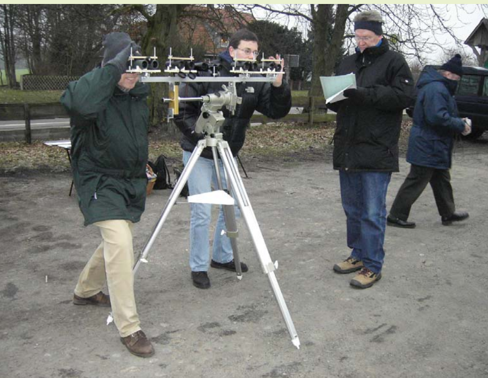
Abb. 3: Für den Test wurden die Gläser mit selbstgefertigten Adaptern aus Holz auf einer parallaktischen Montierung befestigt, da keine Gewinde für einen Stativ-Adapter vorhanden sind. Nur beim Swarovski SLC und beim Vixen-Modell sind diese vorhanden.
