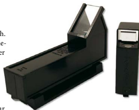
Abb. 3: Telrad und Rigel Quickfinder arbeiten beide nach dem gleichen Prinzip: An eine Sichtscheibe wird ein Aufsuchmuster eingespiegelt.
