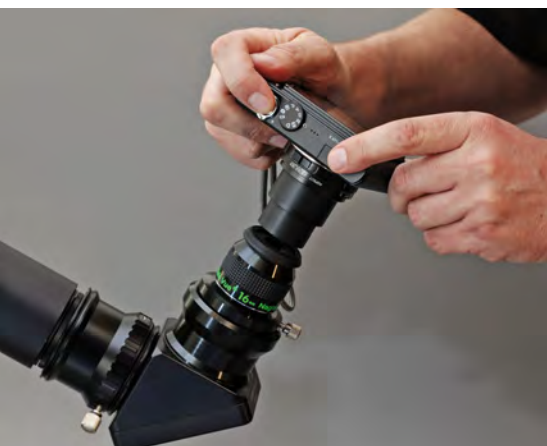
Abb. 4: So entstehen afokale Mondbilder mit einer Digitalkamera: Die Kamera wird einfach hinter das Okular gehalten und abgedrückt. Selbst mit einem Fotohandy lohnt ein Versuch!
