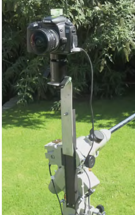
Abb. 4: Damit die Fotos keine Nachführfehler aufweisen, wurde die digitale Spiegelreflexkamera mit einem 8mm-Objektiv an einer parallaktischen Montierung montiert.
