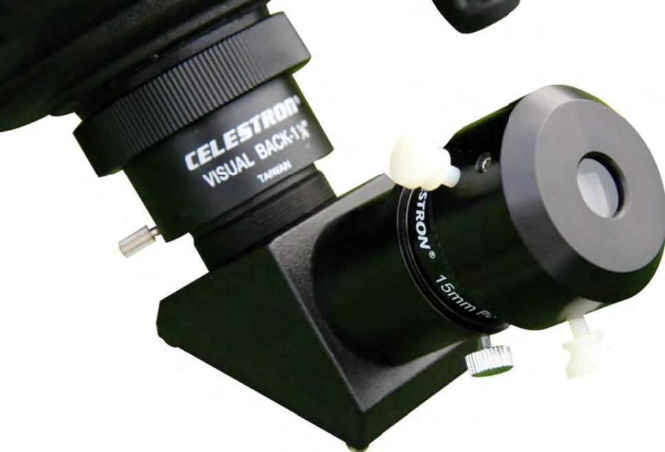
**Abb. 4: Das Rainbow Optics Star Spectroscope** beim Einsatz am Teleskop.
