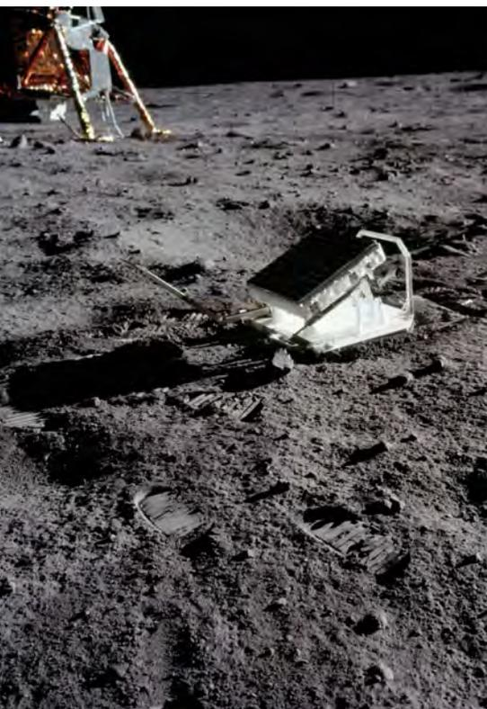
**Abb. 5: Einer der Laserreflektoren**, die während der Apollo-Missionen auf dem Mond installiert wurden. Sie lassen sich von der Erde aus mit Laserstrahlen anpeilen – einer der kaum zu widerlegenden Gegenbeispiele für die angebliche Verschwörung.
