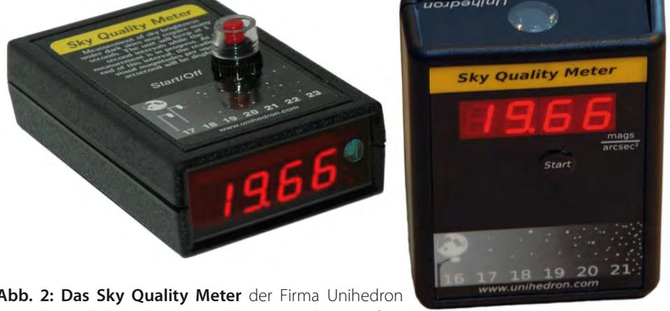
Abb. 2: Das Sky Quality Meter der Firma Unihedron misst die Helligkeit des Himmelshintergrunds in Größenklassen pro Quadratbogensekunde. Links das Standardmodell, rechts das Modell mit Linse.
