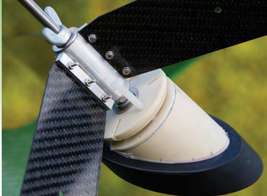
**Abb. 8: Detailaufnahme des Zentralstückes** zur Aufnahme der Fangspiegelhalterung und der Streben am fertigen Teleskop.
