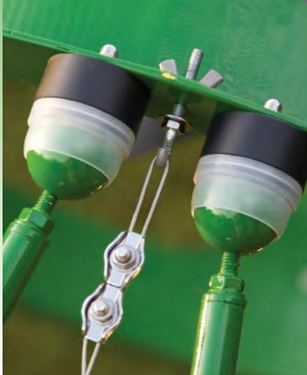
**Abb.7: Die Kugeldruckverspannung**, die die Gitterrohrkonstruktion stabilisiert, am fertigen Teleskop. Kugeln an den Enden der Gitterrohrstangen schnappen in passende Fassungen und werden durch gespannte Edelstahlseile hineingepresst.
