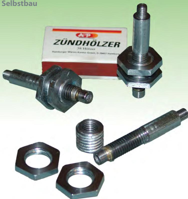
**Abb. 6: Die fertigen Lagerzapfen:** hinten die fertig montierte Version, im Vordergrund die Einzelteile zerlegt.
