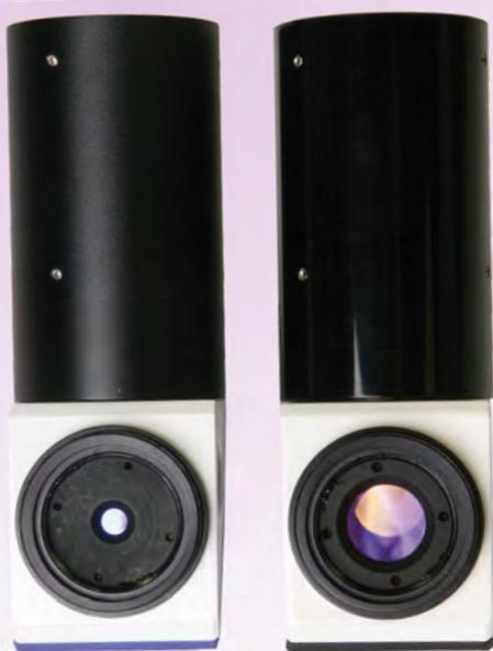
**Abb. 4: Die B600- und B1800-CaK-Module im Vergleich.** Deutlich ist der Unterschied des Filterdurchmessers zu erkennen.
