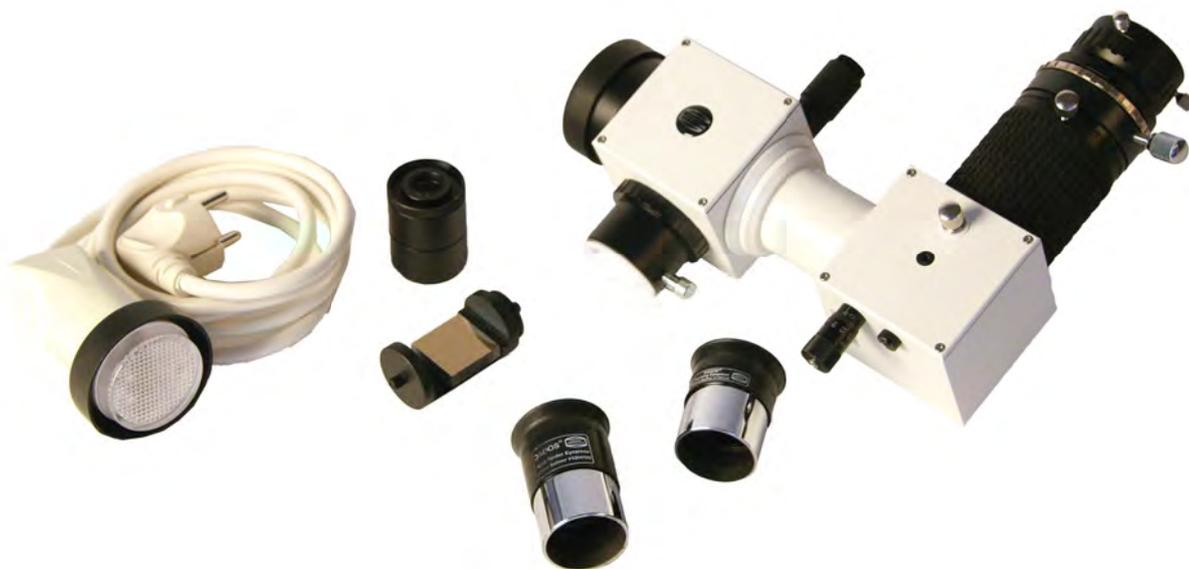
**Abb. 2: Der DADOS-Spektrograph mit Zubehör.** Vorne sieht man von links nach rechts die Neon-Kalibrationslampe, den »SlitViewer«, das Reflexionsgitter in seiner Schnellwechselfassung und die zwei Kellner-Okulare. Gut zu erkennen sind auch die Anschlüsse für die Nachführeinrichtung am linken Würfel und ein Okular am rechten Würfel des DADOS.
