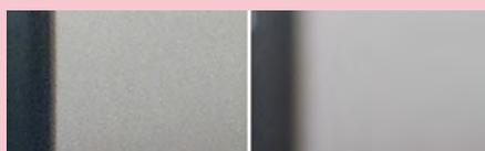
**Abb. 2:** Zwei Ausschnitte von Testaufnahmen, die mit unterschiedlichen Kameras bei gleicher ISO-Einstellung aufgenommen wurden, die linke mit einer Leica D-LUX 3 (Sensorgröße 8,6mm × 4,8mm), die rechte mit einer Canon EOS 5D (Sensorgröße 35,8mm × 23,9mm).
