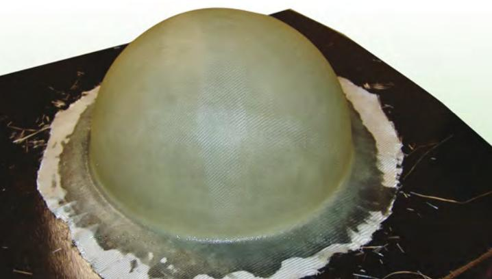
**Abb. 3: Die beiden fertigen Kugelhälften.** Sie sind bereits grob bearbeitet.
