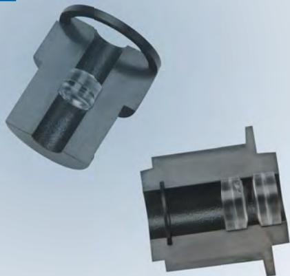
**Abb. 4: Selten kann man das Innenleben eines Okulars derart anschaulich betrachten:** Plössl-Bauweise mit vier Linsen in zwei Gruppen (rechts) und Galilei-Bauweise mit zwei Linsen (links), gleichzeitig als Barlowlinse dienend.
