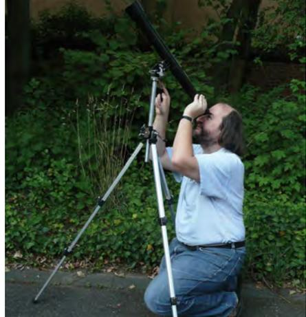
**Abb. 5: Ein höhenverstellbares Stativ ist empfehlenswert,** um flach und hoch stehende Objekte zu erreichen, denn ein Zenitprisma lässt der kurze Fokussierweg nicht zu.
