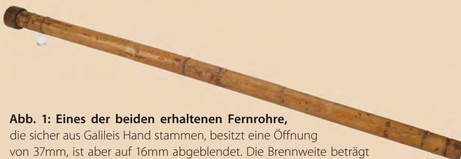
**Abb. 1:** Eines der beiden erhaltenen Fernrohre, die sicher aus Galileis Hand stammen, besitzt eine Öffnung von 37mm, ist aber auf 16mm abgeblendet. Die Brennweite beträgt 980mm, die Vergrößerung 21x.
