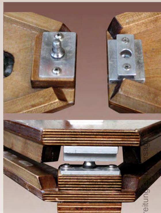
**Abb. 4: Das Südlager** kann als einfaches, aber effektives Zapfenlager ausgeführt werden.
