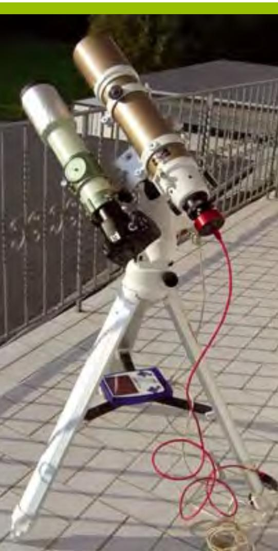
**Abb. 2:** Die für den Test verwendete Konfiguration: Vixen Sphinx SXD-Montierung mit fotografischem 3"-Refraktor mit 500mm Brennweite und 3,5"-Nachführrefraktor mit 600mm Brennweite.
