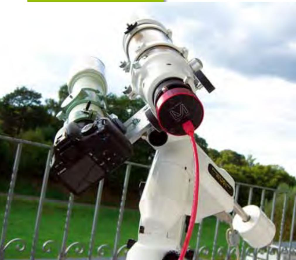
**Abb. 1: Astrofotografie mit parallel montiertem Aufnahme- (links) und Leit-Fernrohr (rechts) ist heute Standard.** Setzt man einen Autoguider ein, entfällt die mühsame manuelle Nachführkontrolle. Der LVI-Smartguider kann im Unterschied zu anderen Autoguidern im »Stand alone«-Betrieb ohne PC verwendet werden.
