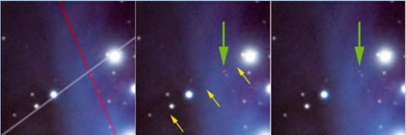
Abb. 2: Stacking-Ergebnis von vier Einzelaufnahmen. In eine der Aufnahmen wurde eine weiße Linie mit drei Pixeln Breite eingezeichnet, in eine andere eine rote Linie, fünf Pixel breit. Damit wurden zwei sich kreuzende Flugzeugspuren simuliert. Links: Modus Durchschnitt. Deutlich sind die beiden Flugzeugspuren zu sehen. Mitte: Modus Median. Die gelben Pfeile deuten auf winzige Reste der weißen Fliegerspur, während der grüne Pfeil auf das Artefakt im Kreuzungsbereich zeigt. Rechts: Modus Kappa-Sigma-Clipping (Kappa=1, 5 Iterationen). Die Flugzeugspuren sind vollständig verschwunden, nur der Kreuzungspunkt zeigt noch einen Artefakt (grüner Pfeil).
