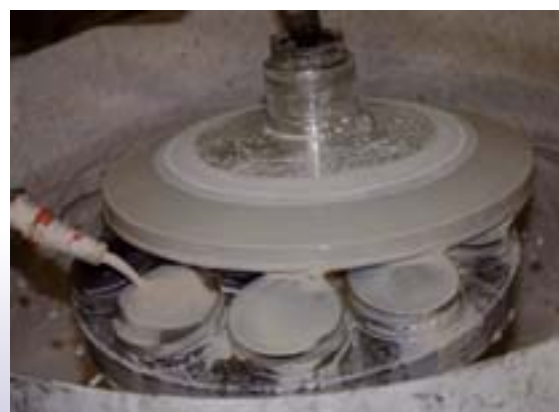
Abb. 5: Polieren mehrerer konvexer Linsen auf einem Träger. Als Poliermitteln werden Oxide (z.B. Eisenoxid oder Titanoxid) mit unterschiedlichen Korngrößen, die mit Wasser und gegebenenfalls weiteren Zusätzen zu einer dünnflüssigen Paste angerührt werden, verwendet.
