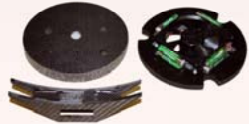
Abb. 5: CFK- und Sandwichbauteile, die hochpräzise auf einer CNC-Maschine gefräst wurden.
