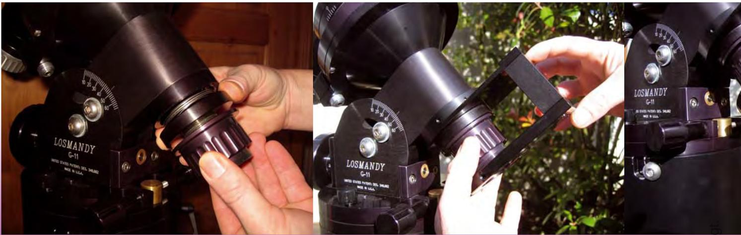
**Abb. 5: Adaption des TDM an die Losmandy G11-Montierung.** Zuerst wird die Klemmung der Rektaszensionsachse von der Montierung abgenommen, dann die Spindel in die Rektaszensionsachse eingeführt und mittels Inbusschraube verankert. Zuletzt wird die Adaption für den Encoder an die Montierung angebracht und der Encoder mit der Halteplatte der Adaption verschraubt.
