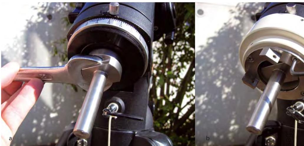
**Abb. 4: Adaption des TDM an die Skywatcher HEQ-5-Montierung.** Zuerst wird die Spindel anstelle des Polsuchers in die Polachse eingeführt und mit einem Gabelschlüssel fest geschraubt, dann wird die Adaption inklusive Halteplatte für den Encoder an der Montierung angebracht. Schließlich wird der Encoder auf die Spindel gesteckt und mit der Halteplatte verschraubt. Zuletzt wird die Verschlusskappe zum Schutz des Encoders hinzugefügt.
