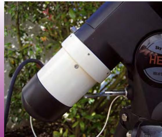
**Abb. 7:** Bei der HEQ-5-Montierung kann die Stellschraube zur Polhöhenverstellung mit der Umhausung für den Encoder zusammenstoßen.
