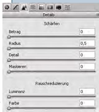
**Abb. 2: Beim »Entwickeln«** aller RAW-Testaufnahmen ist auf eine komplette Abschaltung von Schärfung und Rauschreduzierung zu achten.
