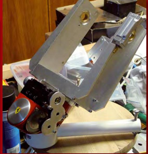
**Abb. 3: Die Gabel im Rohzustand.** Es fehlen noch die Bohrungen und Fräsungen sowie die Lackierung.
