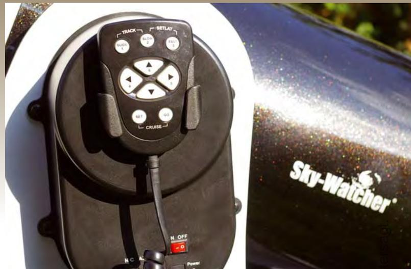
Abb. 4: Details des Sky-Watcher-Dobsons: Höhenlager und Handsteuerbox.
