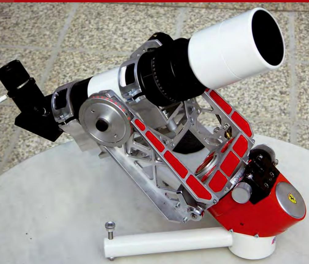
**Abb. 1:** Ein kleines Fernrohr ist für den Urlaub ideal – oft fehlt aber eine passende leichte und dennoch stabile Montierung. Aus den Resten einer New Polaris-Montierung ist diese formschöne Lösung entstanden.
