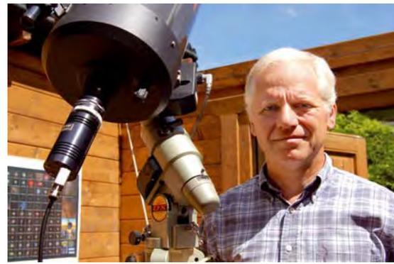
**Abb. 5: Der Autor in seiner Sternwarte** neben dem Teleskop und der Astrokamera. Zwischen Kamera und Teleskop ist der um 120° drehbare Polarisationsfilter montiert. Die drehbare Filterkonstruktion wurde selbst aus Zwischenringen und Fotozubehör gebastelt.
