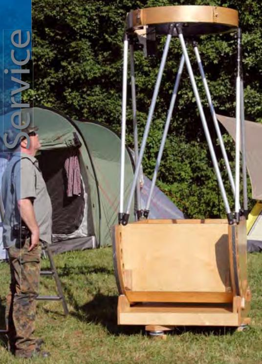
▲ **Abb. 1: Eines der größten Teleskope beim 20. ITV:** Das Dobson-Teleskop von Kai Kretzschmar mit selbstgeschliffenem 28"-Hauptspiegel, der bei einem Öffnungsverhältnis von  $f/3,1$  und einer Randdicke von nur 25mm nahe an der Grenze des für Amateure Machbaren liegen dürfte.
